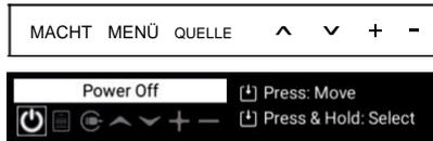
Kurz drücken, um die Tastenliste anzuzeigen, dann links oder rechts klicken, um auszuwählen, lange drücken, um die entsprechende ausgewählte Taste zu senden, die Liste verschwindet automatisch nach 10 Sekunden ohne Aktion.
