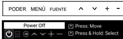
Presione brevemente para mostrar la lista de botones, luego haga clic hacia la izquierda o hacia la derecha para seleccionar, mantenga presionado para enviar el botón seleccionado correspondiente, la lista desaparecerá automáticamente después de 10 segundos sin ninguna acción.
