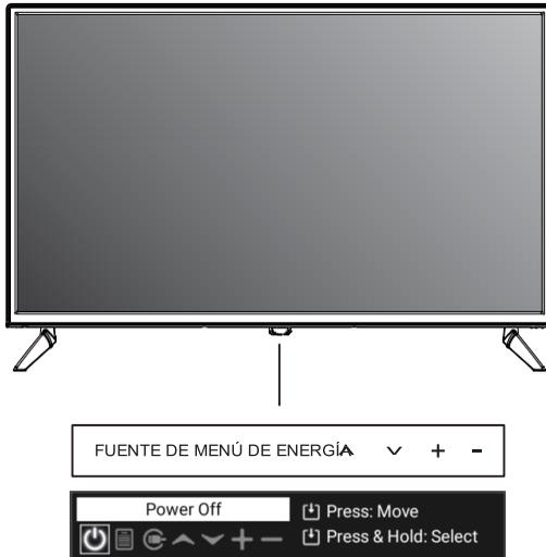
Presione brevemente para mostrar la lista de botones, luego haga clic hacia la izquierda o hacia la derecha para seleccionar, mantenga presionado para enviar el botón seleccionado correspondiente, la lista desaparecerá automáticamente después de 10 segundos sin ninguna acción.
